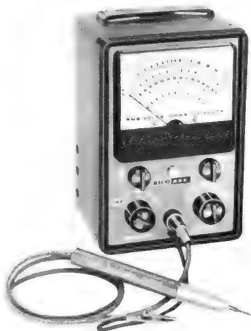
Röhrenvoltmeter Modell 222 mit umschaltbarem Tastkopf
