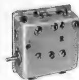
UHF-Converter-Tuner\* zum Einbau in FS-Geräte der deutschen, französischen und US-Norm. Er dient zum Empfang von UHF-Sendern im Bereich von 470-860 MHz. Die Abstimmung erfolgt kapazitiv und nahezu frequenzlinear. Untersetzter Antrieb 1 : 6,5. Antenneneingang: 240 Ω. Antennenausgang: 240 Ω (Kanal 3 oder 4, 54-68 MHz) 35.-
