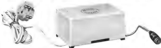
Das Netzspeisegerät für batteriebetriebene Kofferradio – Kleintonbandgerätee, Wechsel- und Funksprechanlagen mit einer Leistung bis zu 300 mA. Techn. Daten: 220 Volt Wechselstrom, sec.-seitig drei verschiedene Grundspannungen 6–7,5–9 Volt **umschaltbar**, Leistungstransistor, Zenerdioden, 2 Elkos, Kleinblockgleichrichter – auf gedruckter Schaltung. Die Einspeisung der anzuschließenden Geräte erfolgt über eine Adapterkupplung mit verschiedenen Adapteranschlußkabeln.
