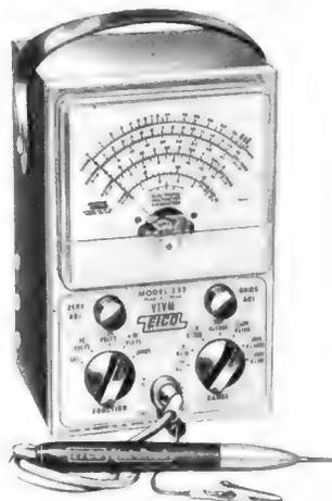
Röhrenvoltmeter Modell 232 mit umschaltbarem Tastkopf
